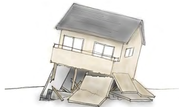
（基礎及び1階部分が崩れた住宅）
